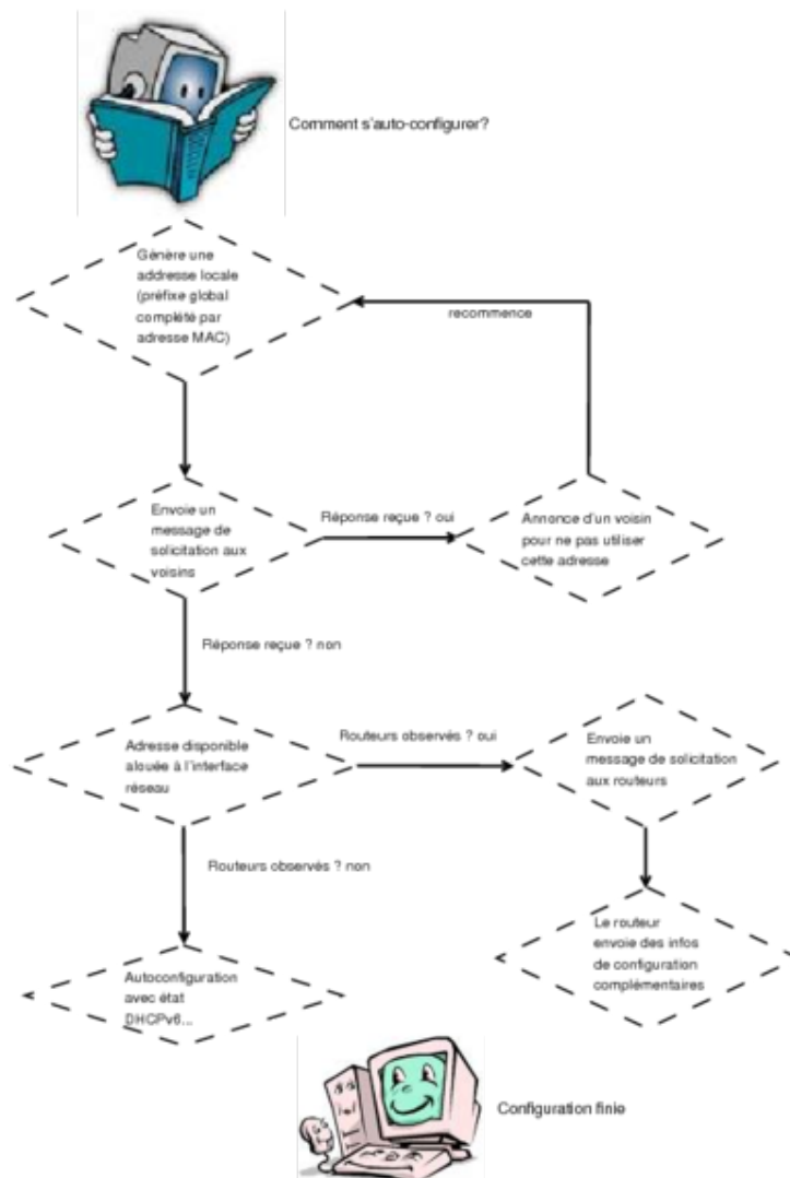
FIG. 3 – Deux méthodes de configuration automatique pour IPv6
